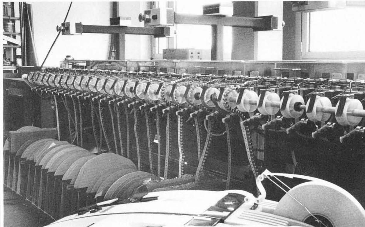
Sequenzerteil mit radialen Gurten geladen. Im Vordergrund das Teletype-Gerät.
