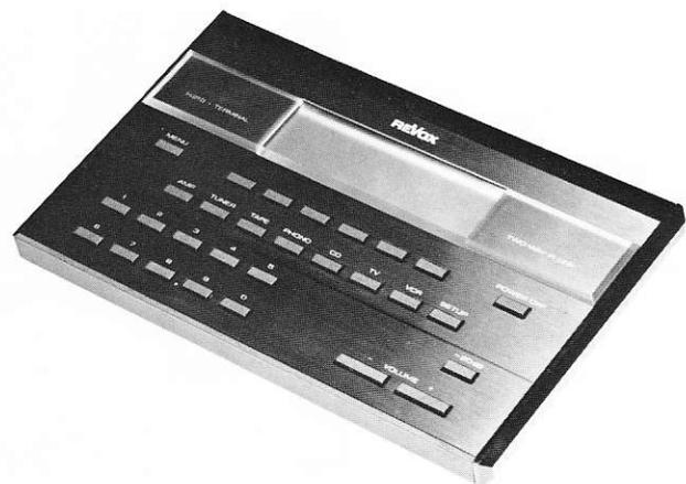
recorder B230S ferngesteuert werden. Die LC-Anzeige informiert über gewählte Quelle, Lautstärke, Balance sowie Klangreglereinstellung, gewählte Lautsprechergruppe, Empfangsfrequenz oder via RDS (Radio Data System) den Namen der gehörten Station. Das Programmieren von 5 Lieblingssendern im
