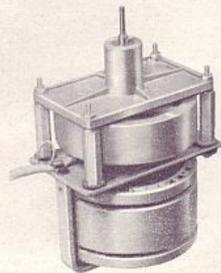
mit einem äusserst geringen Spiel von nur 0,004 mm im Gleitlager aus Sinterstahl mit grosser Oelreserve. Diese Konstruktionsmerkmale in Verbindung mit hochpräzisen Arbeitsmethoden sichern dem Revox Tonbandgerät einen Gleichlauf, welcher hörbare Tonhöheschwankungen auch bei Aufnahme heikelster Musikinstrumente praktisch ausschliesst.
