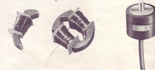
Revox Tonbandgeräte sind mit Ringkernköpfen höchster Präzision ausgestattet. Diese Bauart ist die kostspieligste aller Ausführungsmöglichkeiten — sie findet deshalb auch in den wenigsten Amateurgeräten Verwendung. Ein besonderes Merkmal des Revox Ringkernkopfes sind die genau geläpften Trennflächen und als Ergebnis davon ein absolut gerader Spalt von nur 0,006 mm Breite; der Spaltwinkel lässt sich genau einjustieren. Die einheitliche Einstellung der Tonköpfe auf Grund internationaler Mess-
