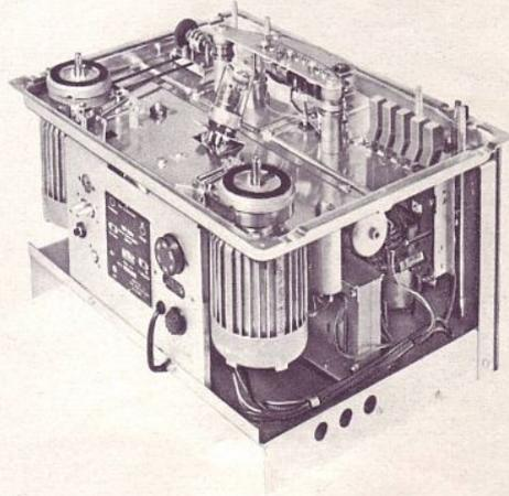
Drei Eingänge erlauben den Anschluss verschiedenartiger Tonfrequenzquellen. Der eine dieser Eingänge lässt sich innerhalb 10—500 mV auf die gewünschte Empfindlichkeit einstellen, womit der Verschiedenartigkeit in der Spannungsabgabe der Diodenausgänge von Rundfunkempfängern Rechnung getragen ist. Getrennte Eingangsregler ermöglichen die gleichzeitige, gemischte Aussteuerung von zwei Eingängen, jeder in der gewünschten Intensität.
